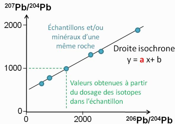
L'âge de la roche s'obtient en comparant le coefficient directeur (a) de la droite isochrone au tableau de calibrage.
